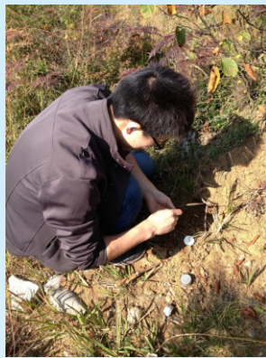
课题研究员在晴隆石漠化现场测量抗剪强度和打环刀采集样品（课题编号：KT201104）
